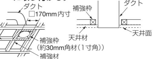
■ダクトの先端は取り付け天井面より出ないようにしてください。給排気グリルが取り付けられなくなります。
