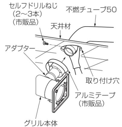
②固定金具を仮止めしているテープをはずし、取り付け穴に差し込む。
