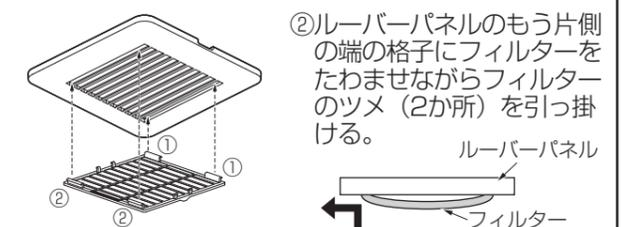
②ルーバーパネルのもう片側の端の格子にフィルターをたわませながらフィルターのツメ (2か所) を引っ掛ける。
