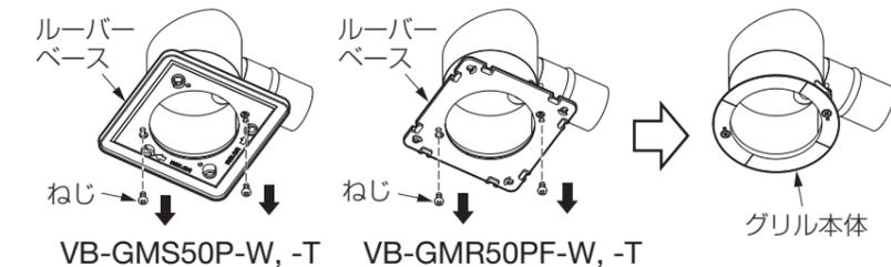
②固定金具を仮止めしているテープをはずし、グリル本体を天井に取り付ける。
