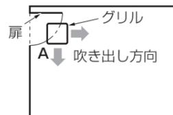
●2か所の場合、1か所は扉側の天井隅(B)に、他は隣接する方向の天井隅(CまたはD)に設置してください。
