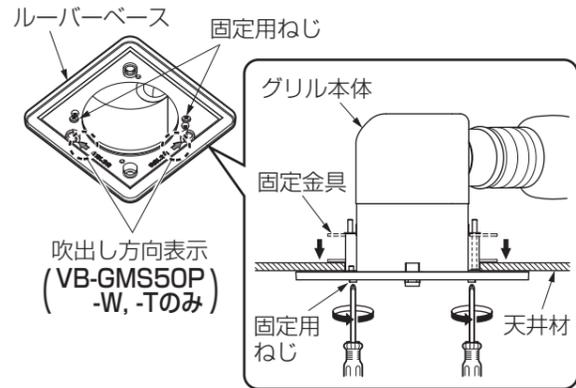
■電動ドライバーご使用時でも最後の締め付けは、手回しドライバーを使用してください。
