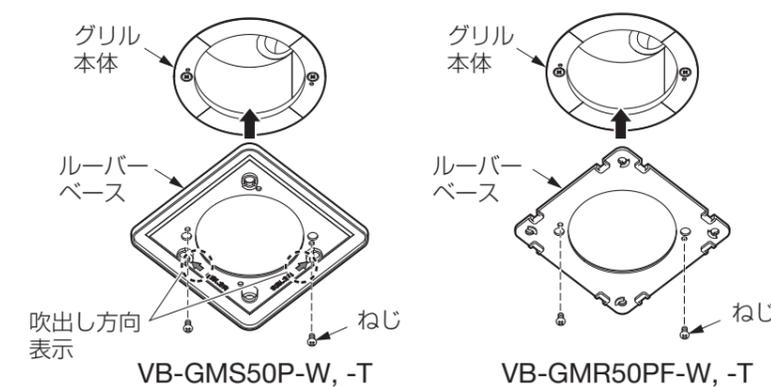
■電動ドライバーご使用時でも最後の締め付けは、手回しドライバーを使用してください。
